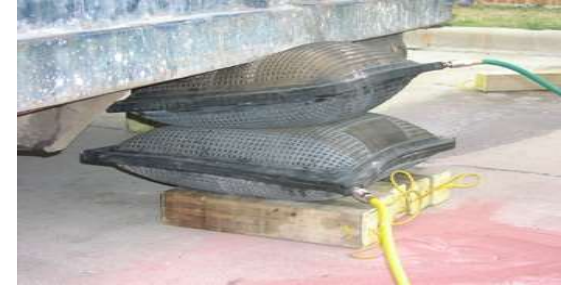
High Pressure Air Bag: স্ল্যাবের উচ্চতা বাড়িয়ে চাপা পড়া ব্যক্তির উদ্ধারের জন্য ব্যবহৃত হয়
